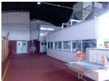
Para ello, adaptamos la infraestructura física de la planta de envasado, la cual cuenta con un sistema de cabinas vidriadas que permiten los controles del envasado y las mezclas sin interferir sanitariamente con la producción.
